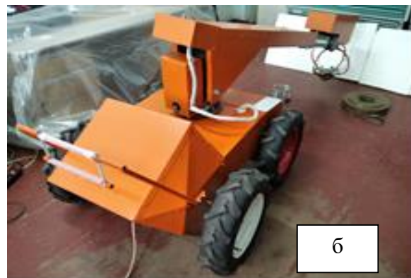
Рисунок 2 – Дистанційно керована рухома платформа ДКРП-1 (лабораторні випробування): а – транспортне положення; б – робоче положення
