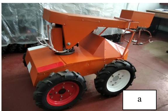
Рисунок 2 – Дистанційно керована рухома платформа ДКРП-1 (лабораторні випробування): а – транспортне положення; б – робоче положення
