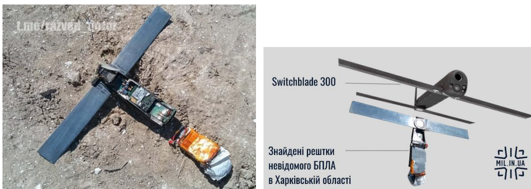
Рисунок 1 – Рештки дрона-камікадзе “Switchblade 300”, знайденого в Харківській області
