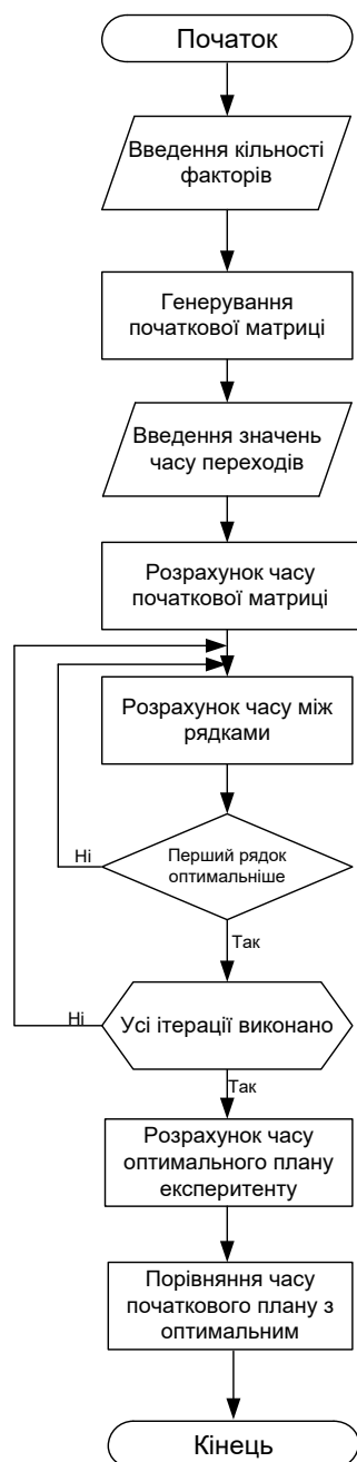
Рисунок 1 – Схема реалізації методу бактеріальної оптимізації
