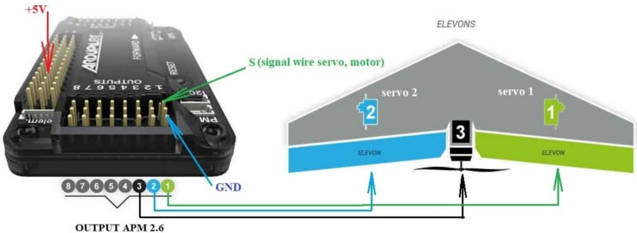
Рисунок 3 – Підключення сервоприводів і мотора до польотного контролера
