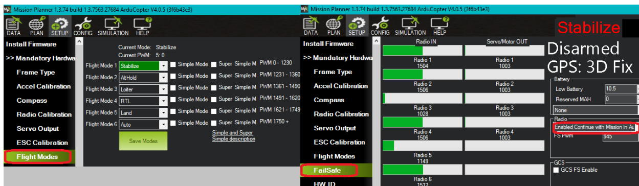
Рисунок 6 – Налаштування польотних режимів і FailSafe
