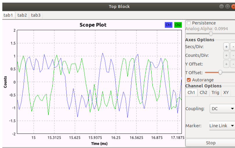
Рисунок 14 – Форма сигналу у часовій області після проходження каналу зв'язку
