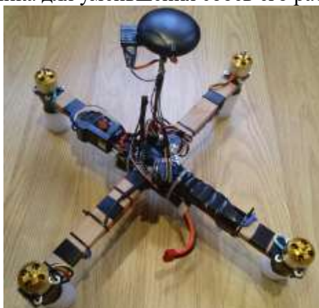
Рисунок 7 – фото экспериментального БПЛА со снятыми пропеллерами
