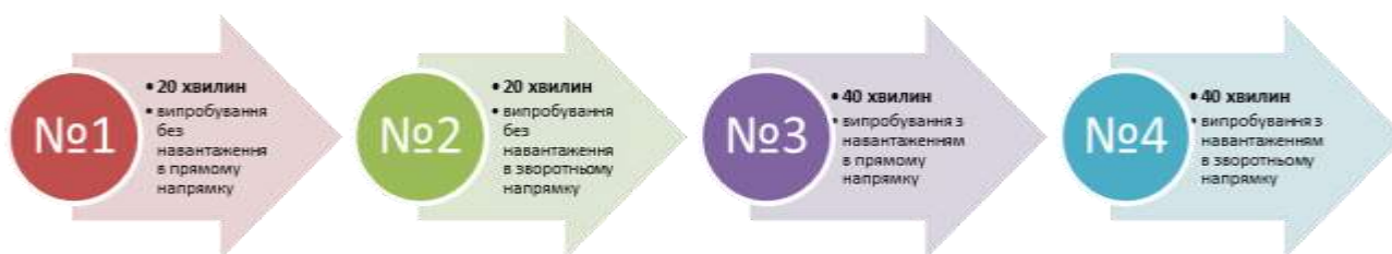
Рис. 4. Режим випробувань редукторів в ПАТ «Укрзалізниця»
